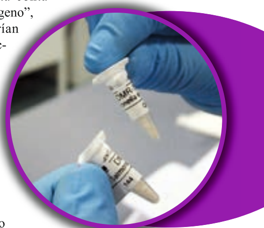
Los Materiales de Referencia Certificados son preparados especiales que se utilizan en los ensayos de alimentos para identificar microorganismos patógenos. Foto cedida por CENAM.
