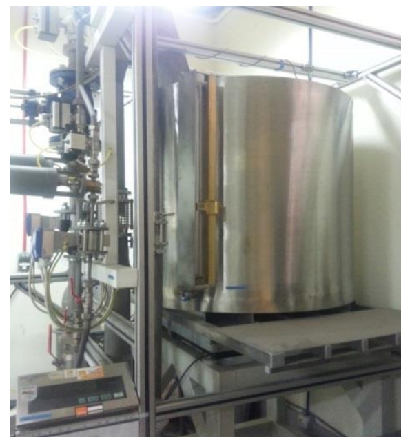
Tanque medidor de volumen
