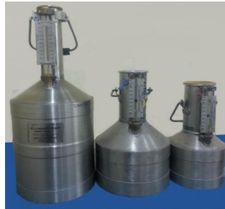
Recipientes volumétricos de 20 L, 10 L y 5 L ( 2 \times 10^1 , 1 \times 10^1 y 5 \times 10^0 )
